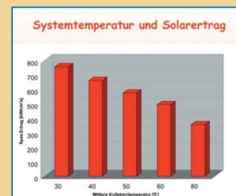
Niedrige Systemheiztemperaturen verbessern den Wirkungsgrad der Solaranlage.
